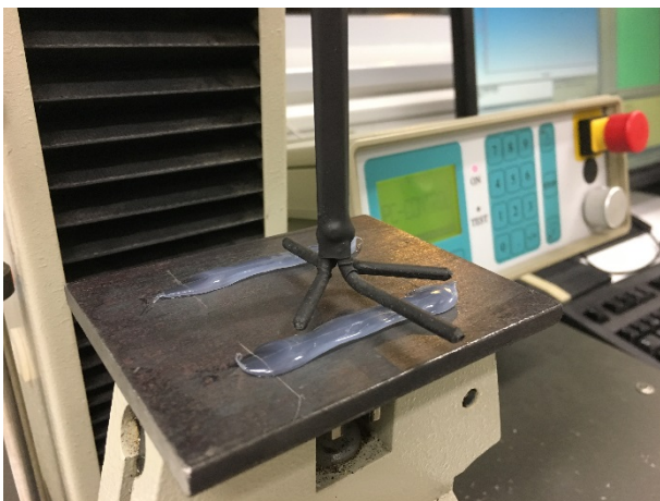
Bild 1: Künstlicher Taubenfuß in der Versuchsanordnung auf der Materialprüfmaschine
