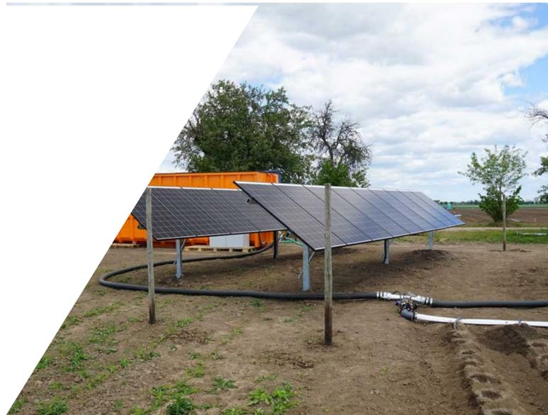
Bild 1: Solarpanels und Bewässerungssystem © IrriMode
