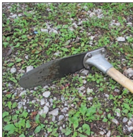
Abb. 7 (links): Hartmannshoe (breites Blatt, Aluflansch), Foto: FZB Magdeburgerforst
