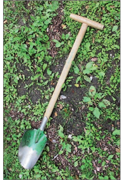
Abb. 4: Hohlspaten „Granit II“, Foto: FBZ Magdeburgerforth
